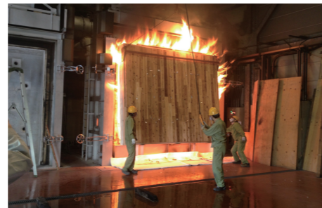
木材外壁の加熱実験の様子
